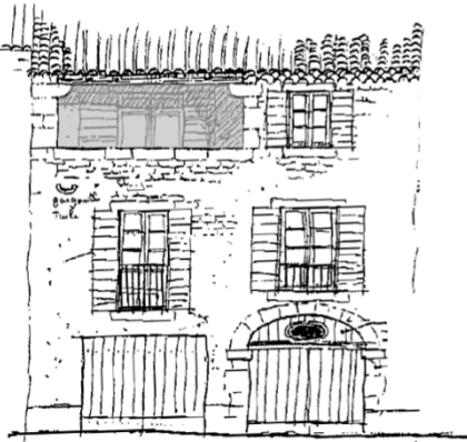
Croquis 3 : Galerie couverte à l'aplomb de la façade
